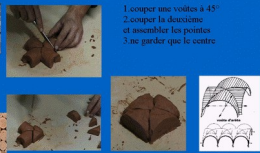
croisée de voûte et voûte d'arête
